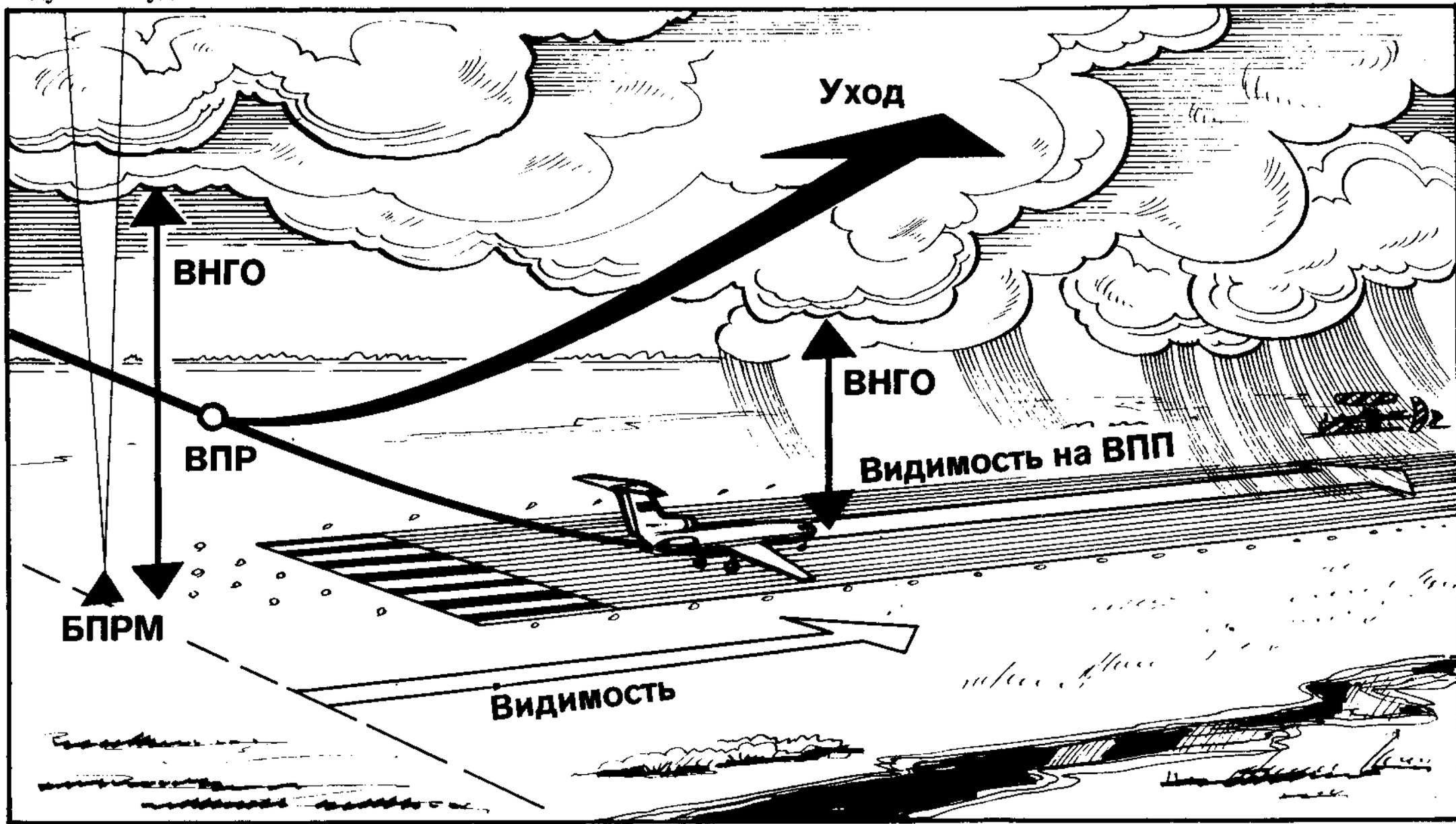
**ПОСАДОЧНАЯ ДИСТАНЦИЯ** — расстояние по горизонтали, проходимое самолетом с высоты 15 м (9 м для самолетов со скоростью захода на посадку менее 200 км/ч при градиенте снижения не более 5 %) над уровнем торца ВПП до полной его остановки.
