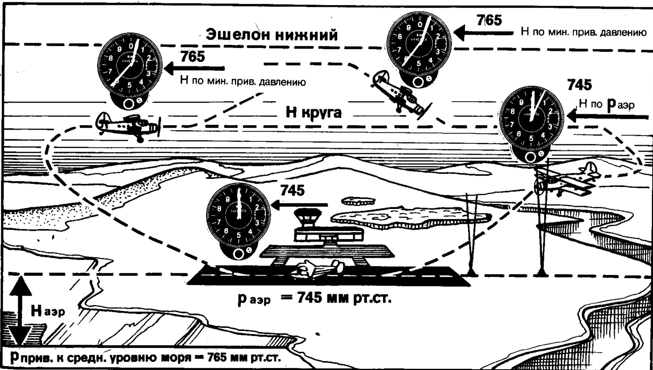
5.6.2. На предварительном старте экипаж обязан установить стрелки барометрических высотомеров на «ноль» высоты и сравнить отсчет на шкале давления со значением атмосферного давления на аэродроме.
