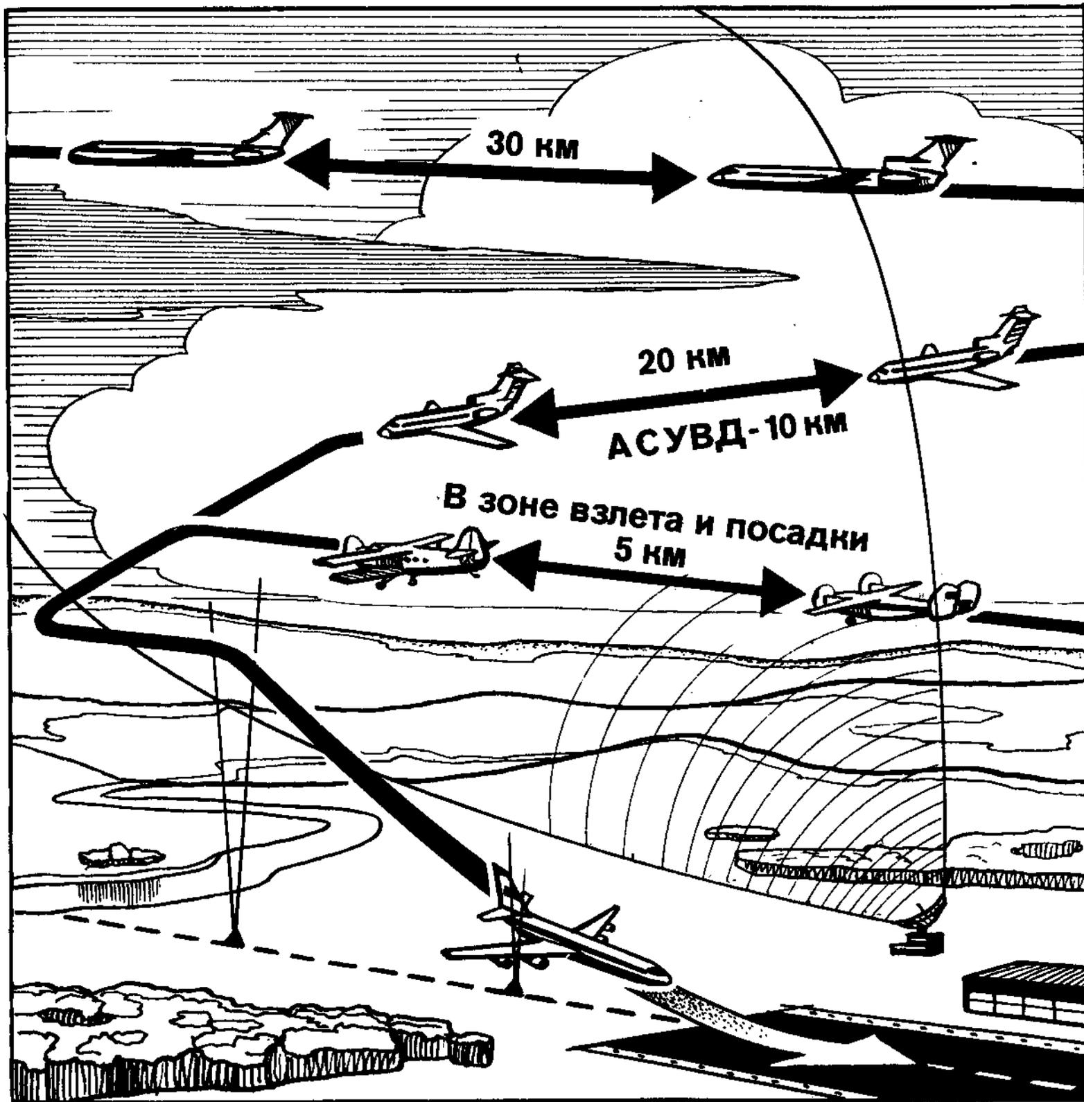
5.9.2. Минимальные интервалы продольного эшелонирования при полетах по ППП (ОПВП) с непрерывным радиолокационным контролем.
