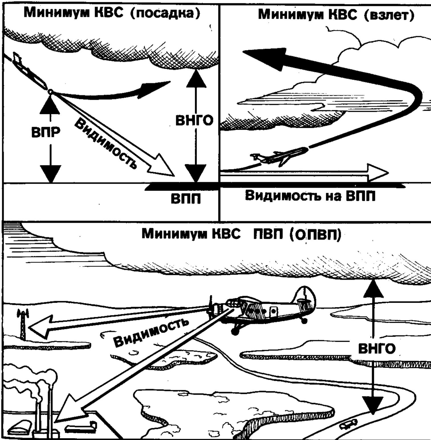
2.7.8. Минимум командира воздушного судна для взлета — минимально допустимое значение видимости на ВПП, при котором командиру разрешается выполнять взлет на воздушном судне данного типа.
