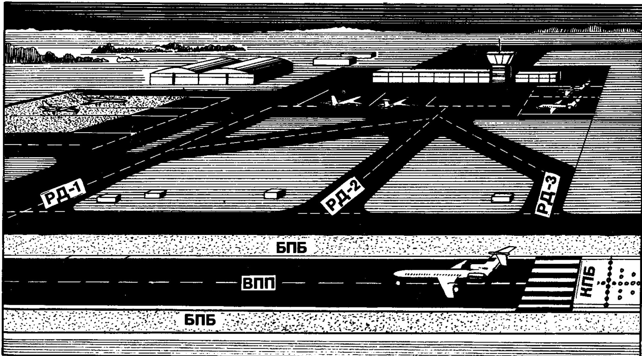
**МИНИМУМ АЭРОДРОМА** — минимально допустимые значения видимости на ВПП (видимости) и ВПР (ВНГО), при которых на данном аэродроме разрешается выполнять взлет и посадку воздушного судна данного типа.
