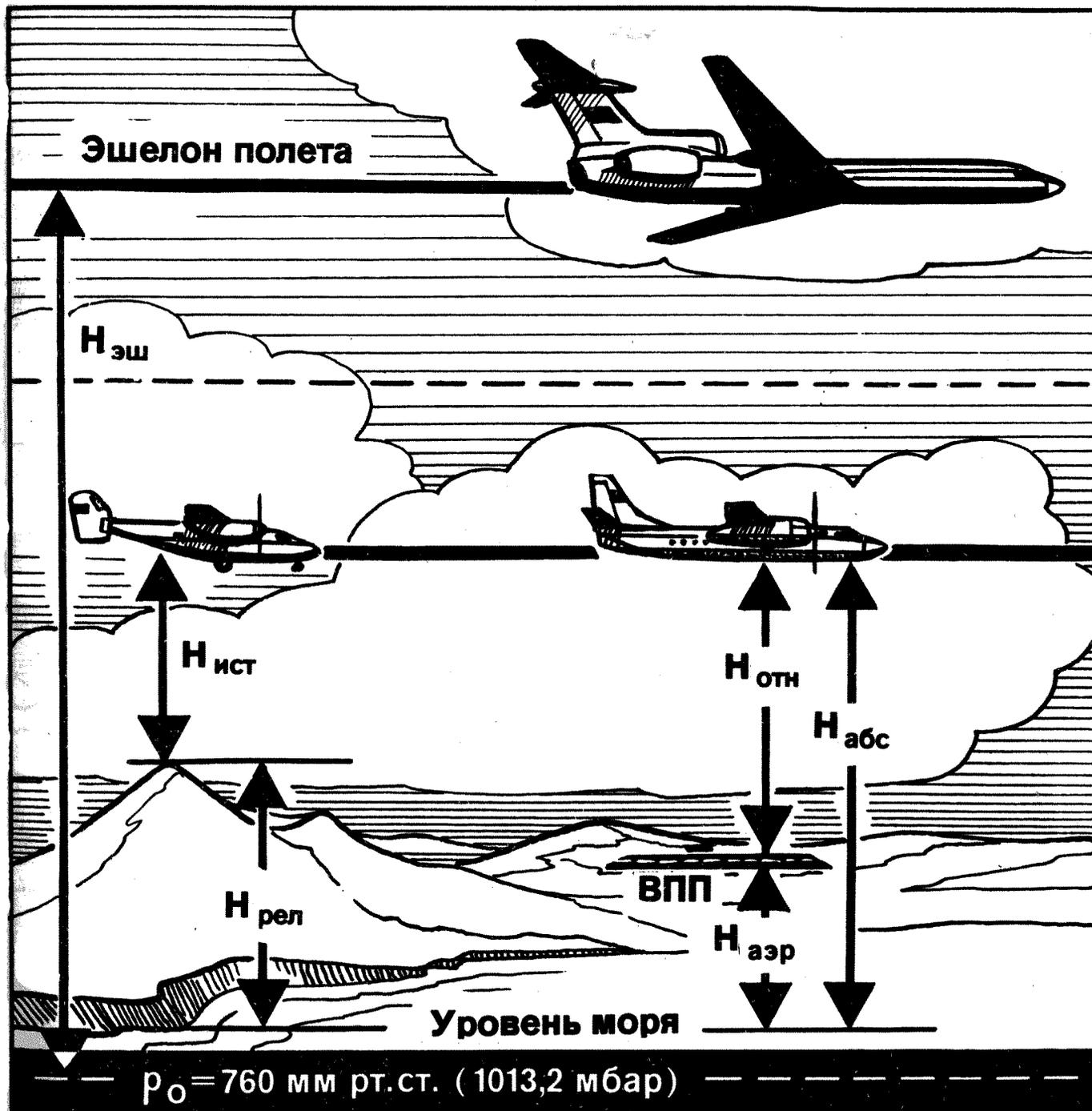
**ВЫСОТА ПОЛЕТА** — расстояние по вертикали от определенного уровня до воздушного судна.
