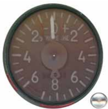
Рис. 8.8.21 Акселерометр АМ-9
