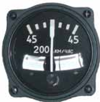
Рис. 8.8.3 Шкала указателя поворота ЭУП-53УК
