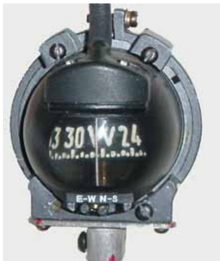
Рис. 8.8.15 Магнитный компас КИ-13БС
