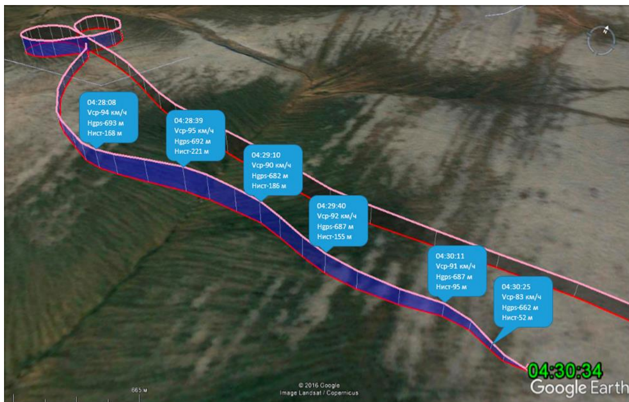
Рис. 9. Профиль полёта самолёта «Птенец-2» RA-0347A 31.10.2015 (заключительный этап)
