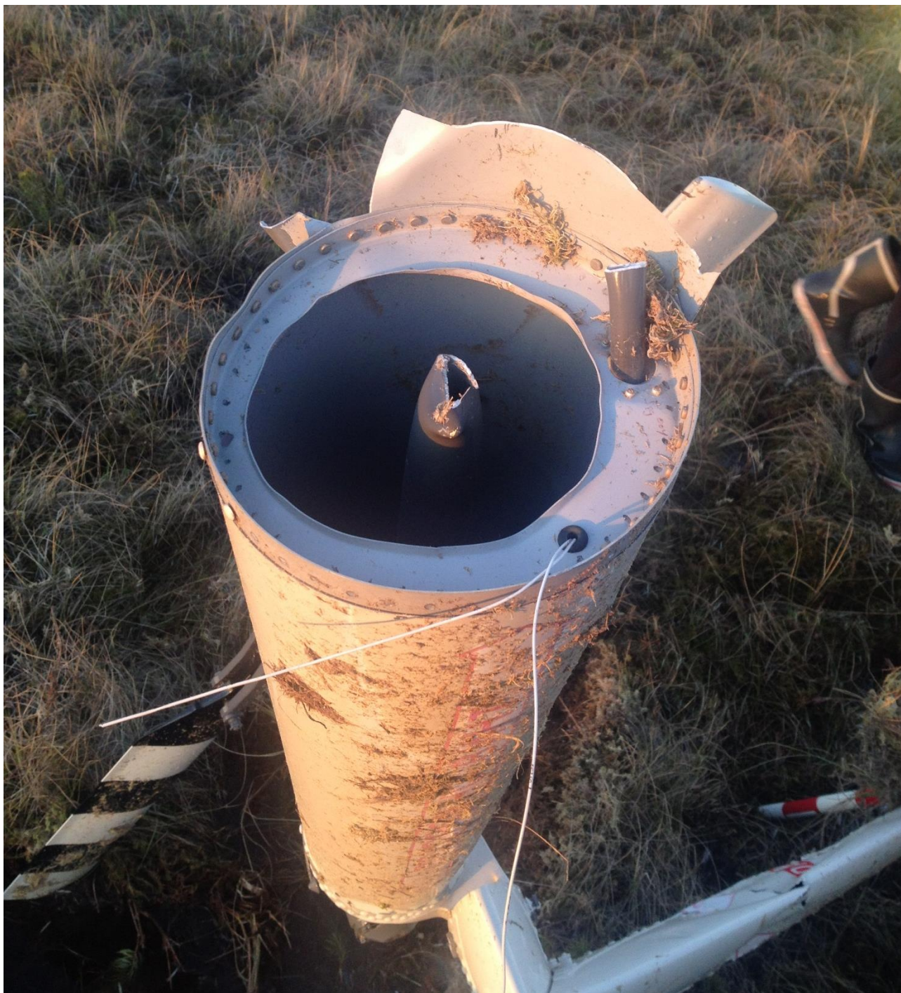
Рис. 6. Разрушение хвостовой балки по силовому шпангоуту
