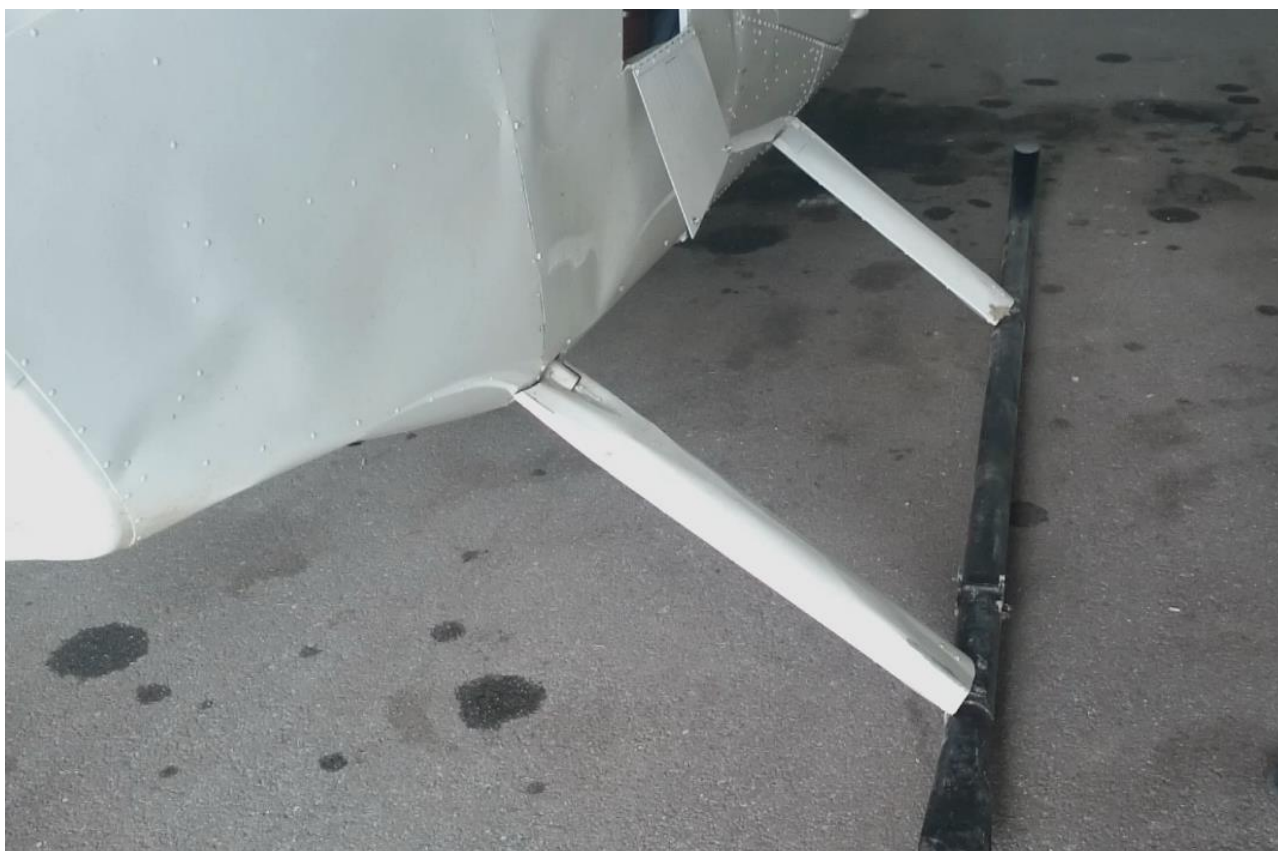
Рис. 4. Состояние посадочного шасси аварийного вертолёта
