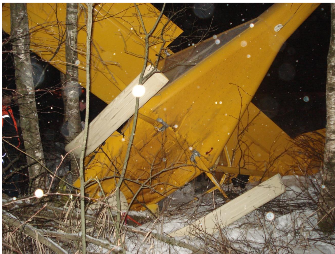
Рис. № 7. Вид на лыжное шасси воздушного судна.
