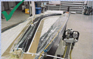
Оснастка для выкладки и вакуумирования пакета
