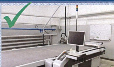
Станок листового раскроя препрега
