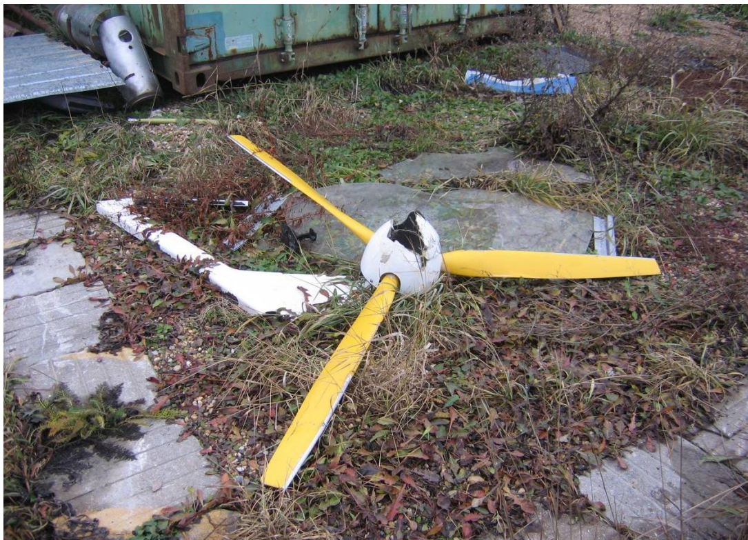
Рис.5. Вид разрушенного воздушного винта.
