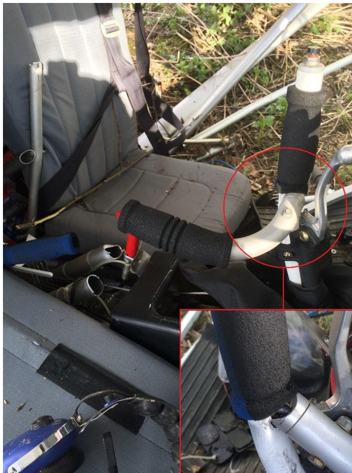
Рис.6 Разрушение дополнительной рукоятки РУС.
