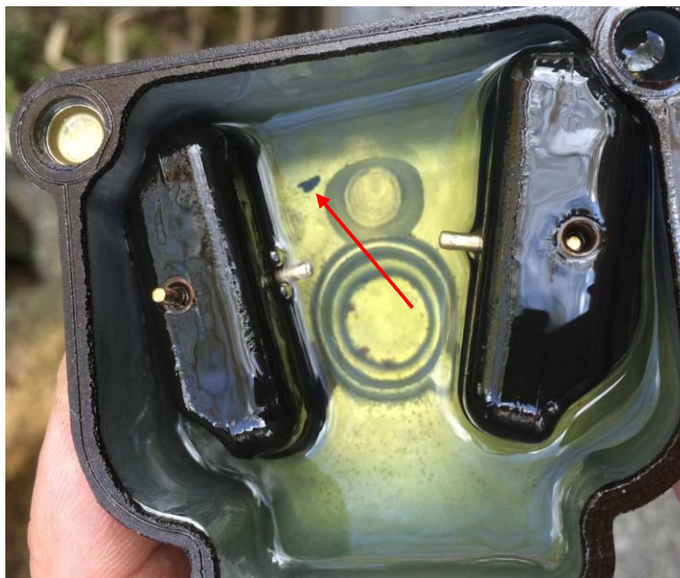
Рис. 7. Поплавковая камера правого карбюратора с кусочком резины.
