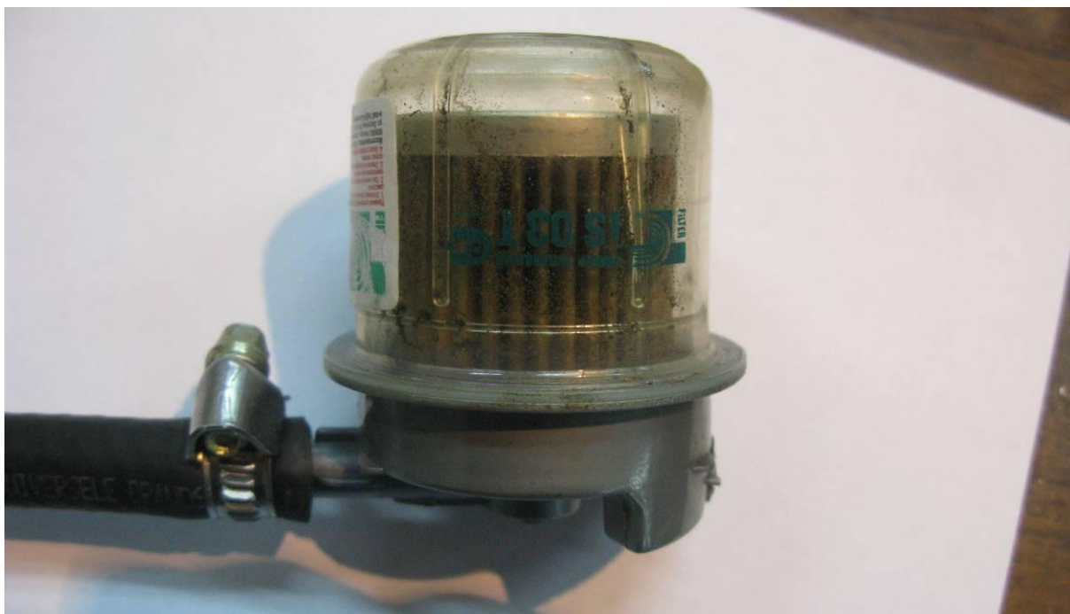
Рис. 15. Вид установленного бумажного топливного фильтра тонкой очистки.
