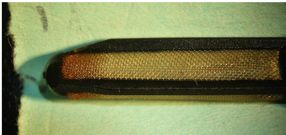
Рис. 14. Встроенный фильтр дополнительного электронасоса.
