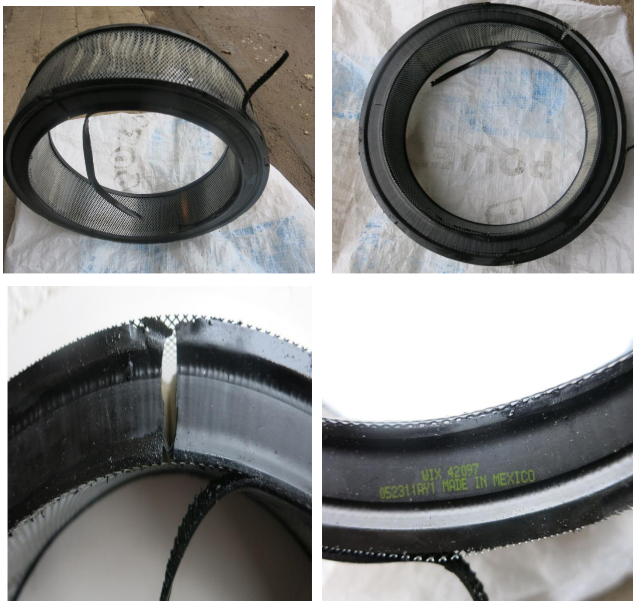
Рис. 2. Состояние воздушного фильтра и его маркировка
