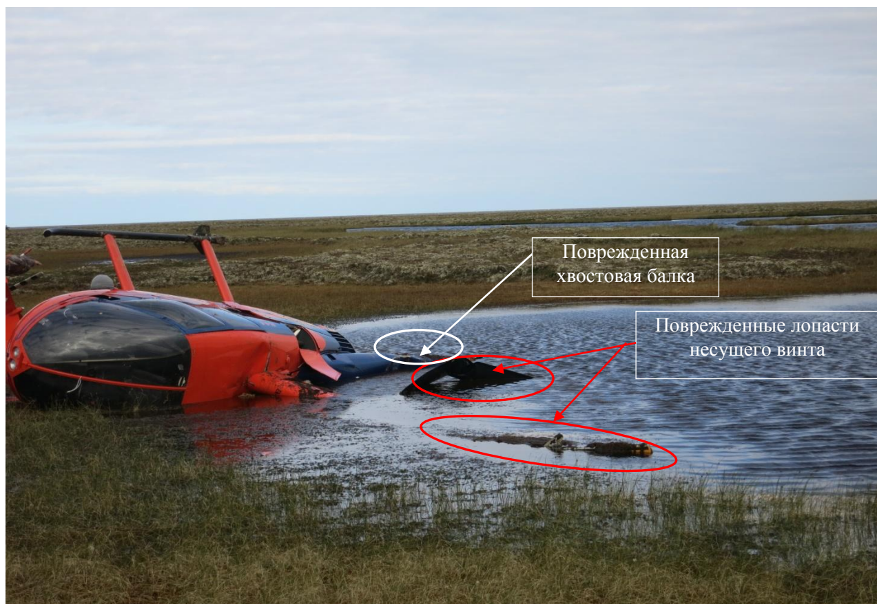
Рис. 7. Расположение поврежденных лопастей НВ и ХБ на месте АП
