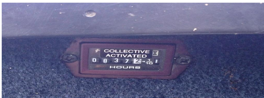
Рис.4. Счетчик наработки двигателя
