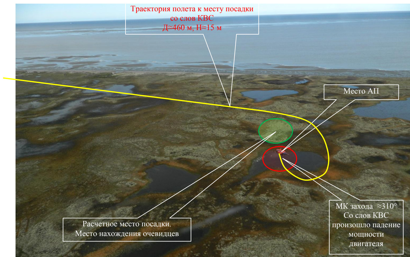
Рис. .10. Траектория движения вертолета (со слов КВС) до места АП
