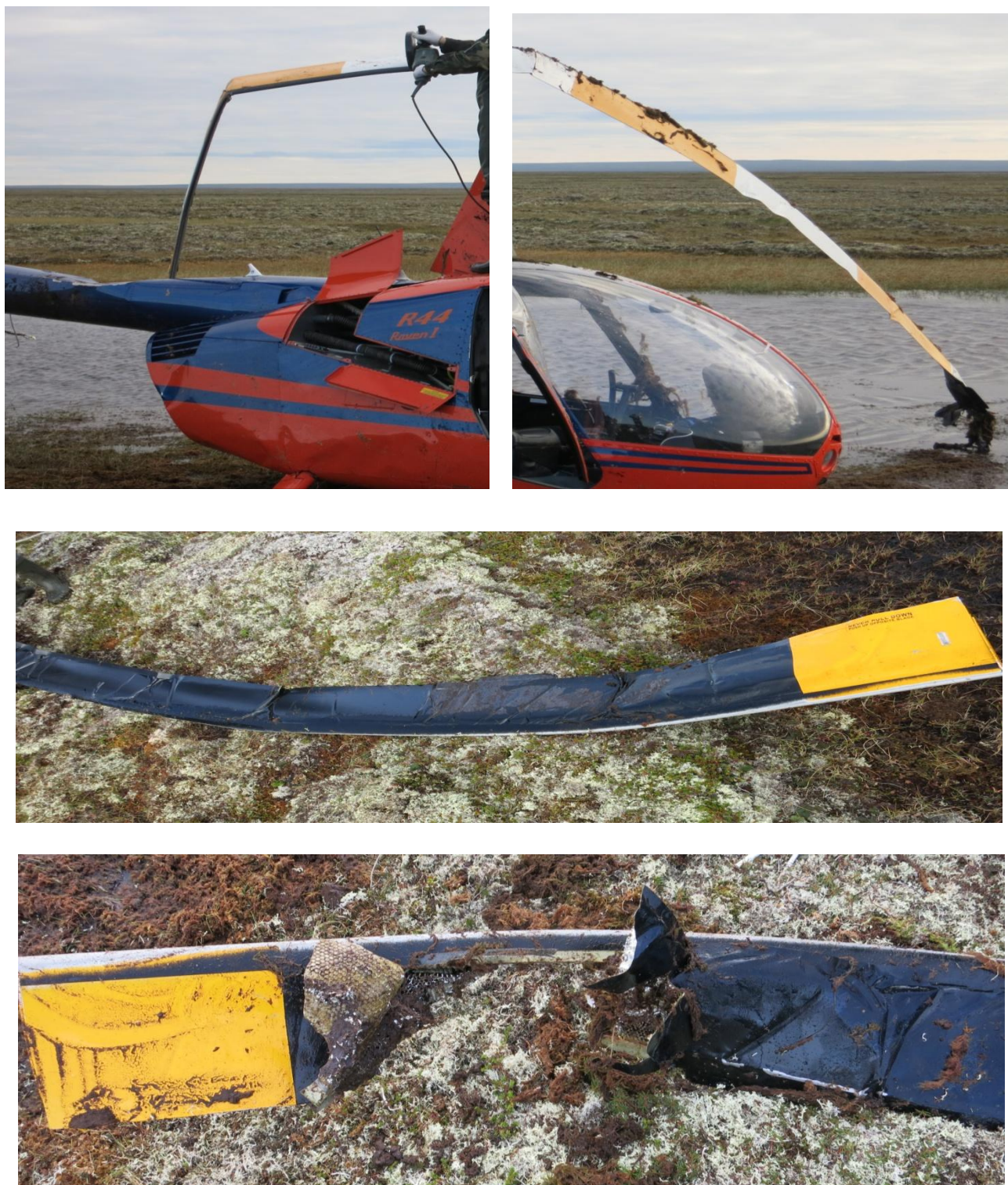
Рис. 9. Состояние лопастей НВ на месте АП
