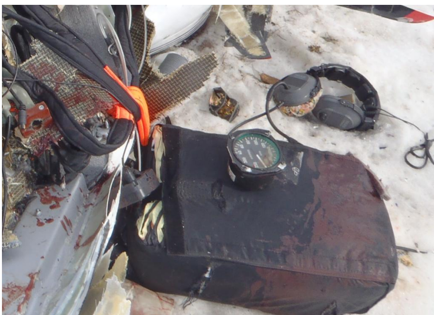
Рис. 4 .Внешний вид БПС после авиационного происшествия.
