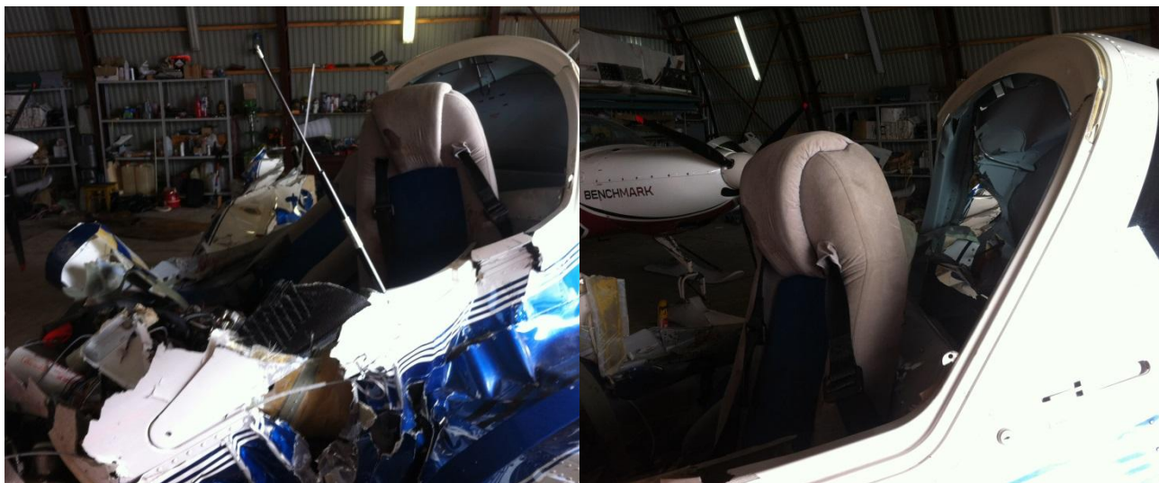
Рис. 5. Внешний вид узлов навески фонаря после авиационного происшествия.
