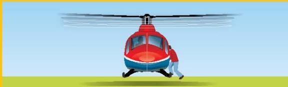
При покидании вертолета с работающим двигателем на высоте выходите из вертолета плавно, без рывков, по команде пилота.
