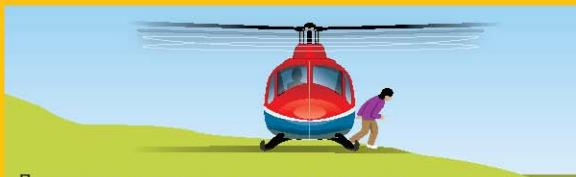
При посадке на склонах выходите из вертолета вниз по склону для максимального удаления от лопастей работающего винта.
