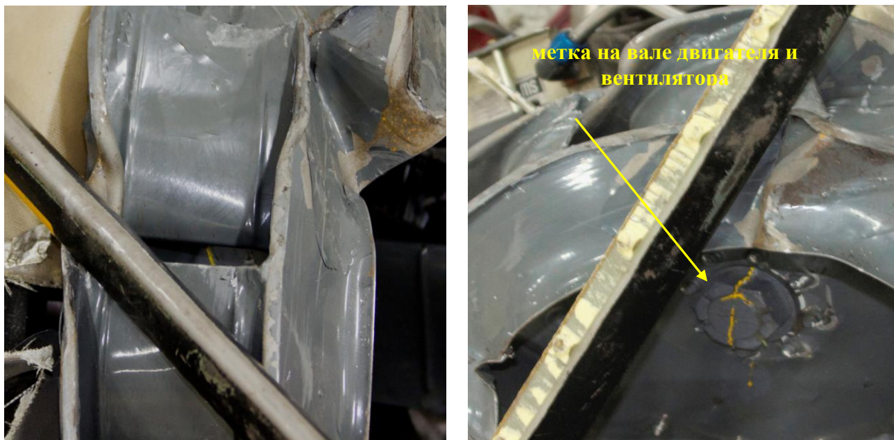
Рис. 2. Характер соударения лонжеронов с вентилятором охлаждения (выкладка фрагментов ВС после АП)
