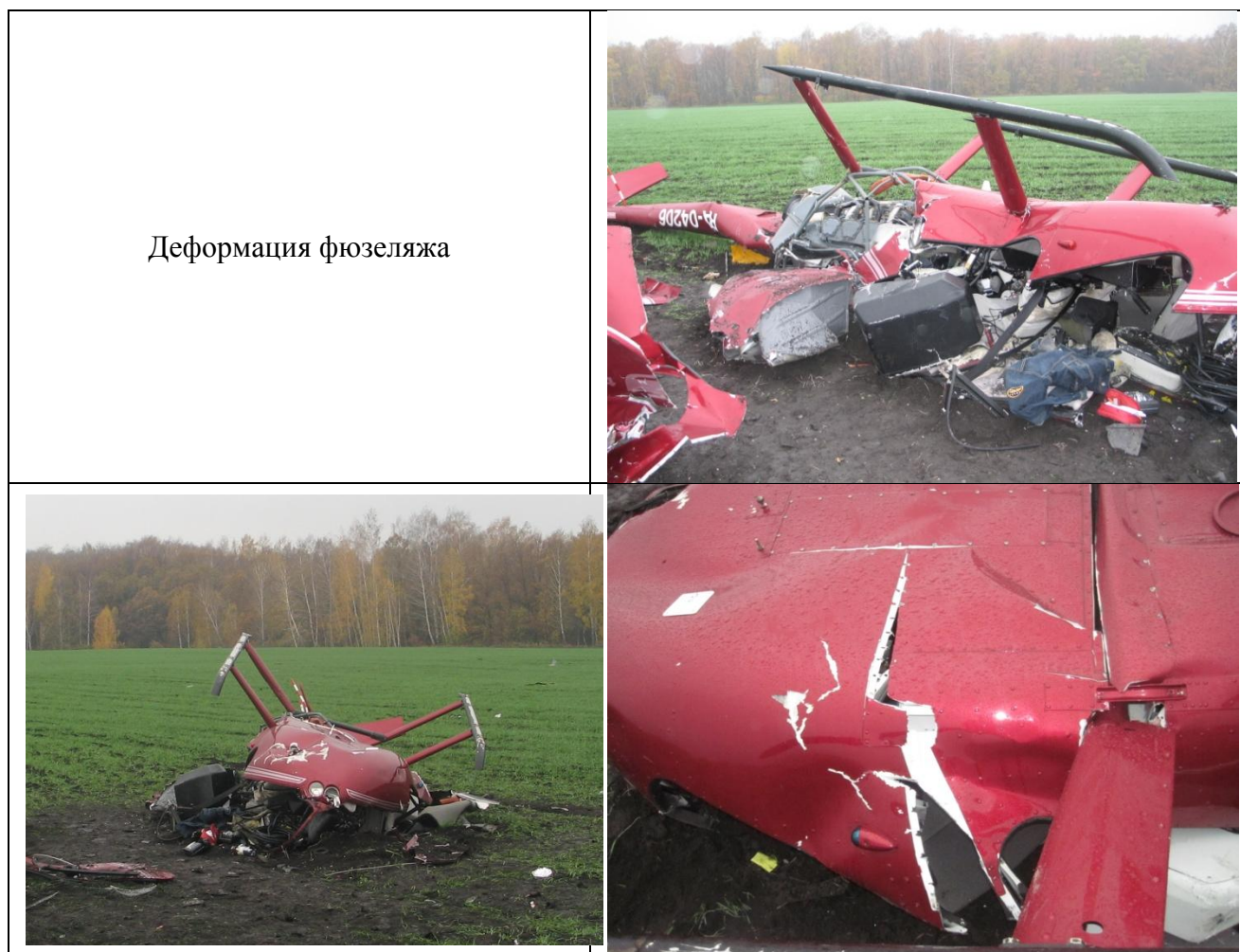
Рис. 4. Состояние элементов ВС на месте АП
