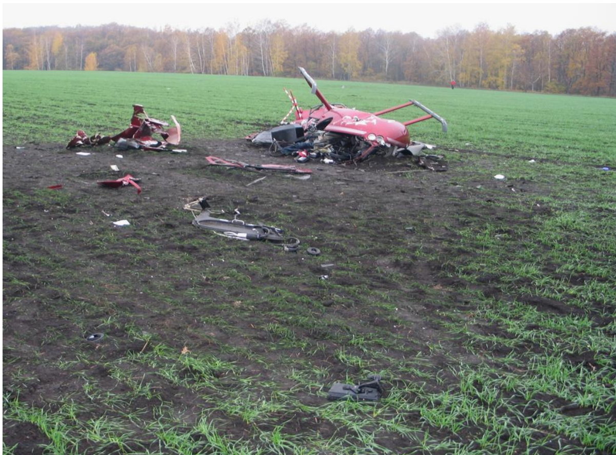
Рис. 1. Общий вид повреждения ВС после АП.
