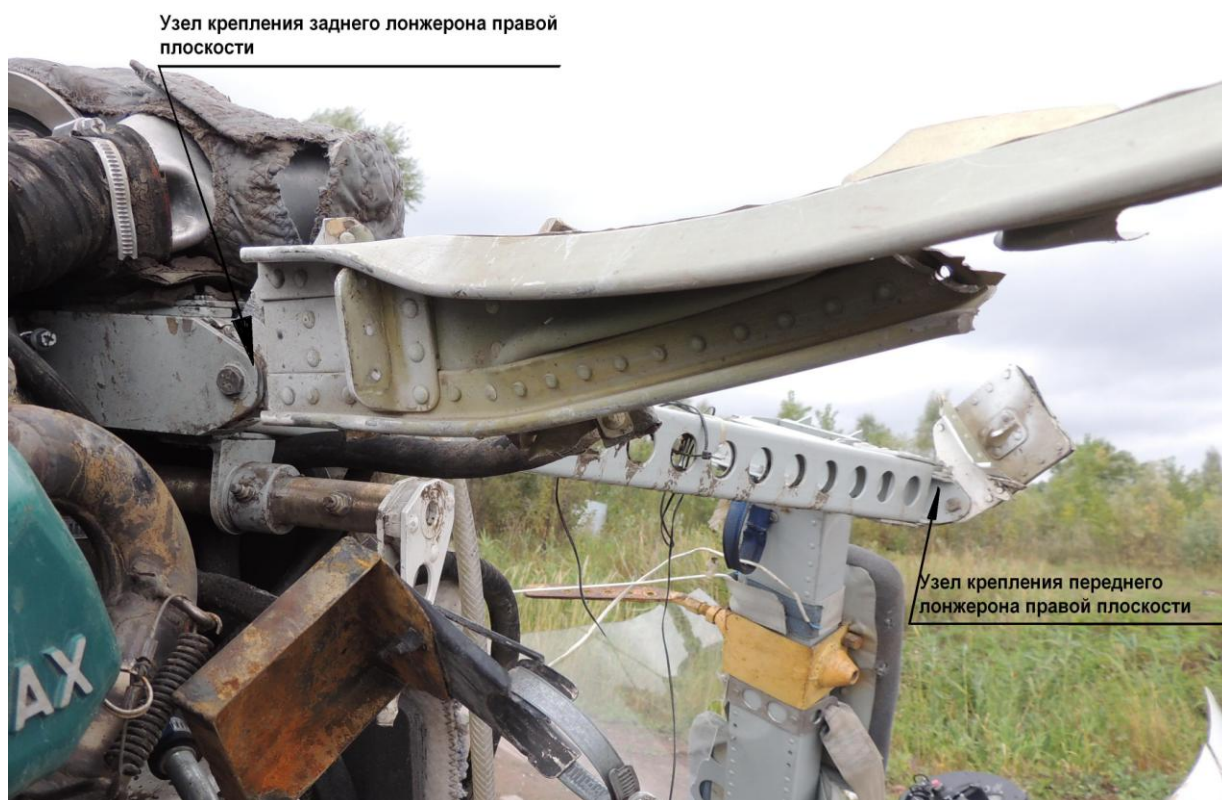
Рис. № 4. Узлы крепления правой плоскости крыла.
