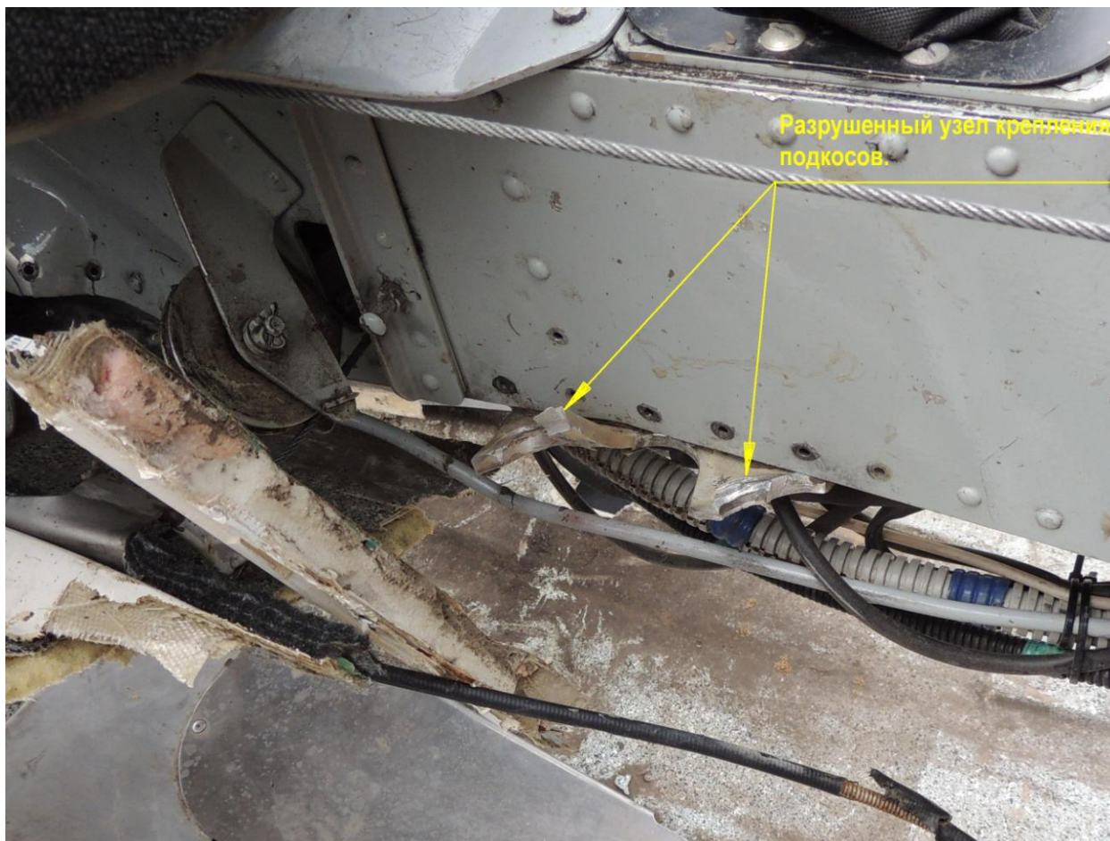
Рис № 7. Сломанные проушины узла крепления подкосов правого крыла.
