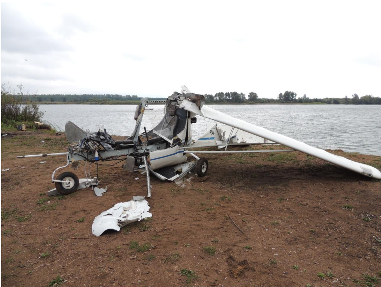
Рис. 1. Разрушенная кабина ВС, извлечённого из воды.
