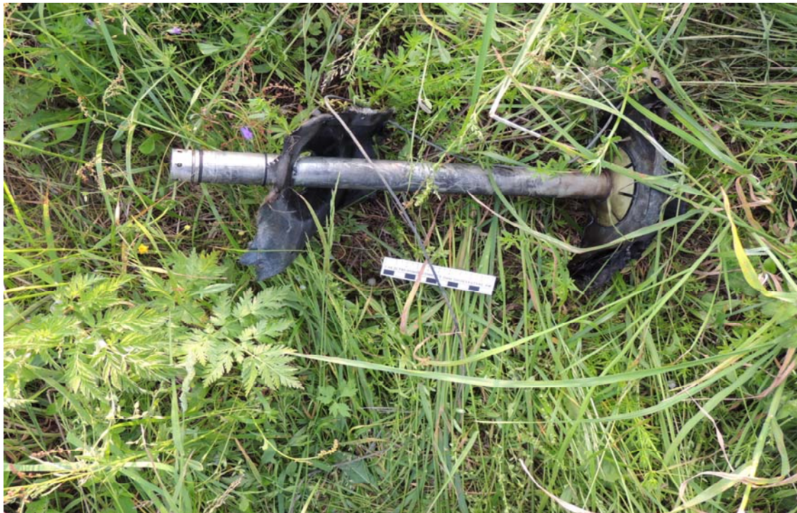
Рис. 11. Поршень пиропатрона спасательной системы
