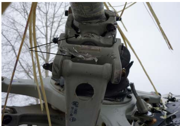
Рис. 5 Задира металла на поводке автомата перекося
