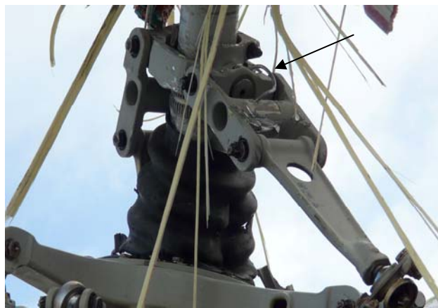
Рис. 6 Фрагмент металлической проволоки
