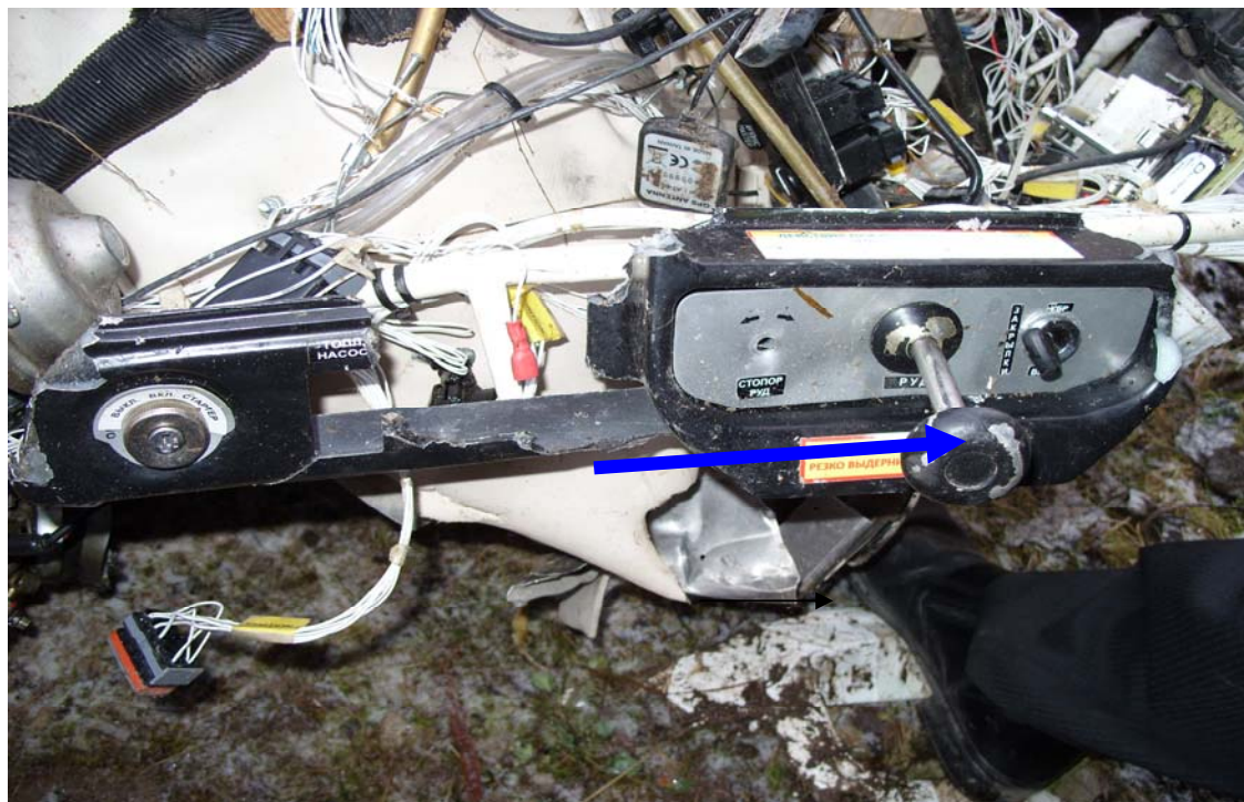
Рис. 4. Рычаг управления двигателем
