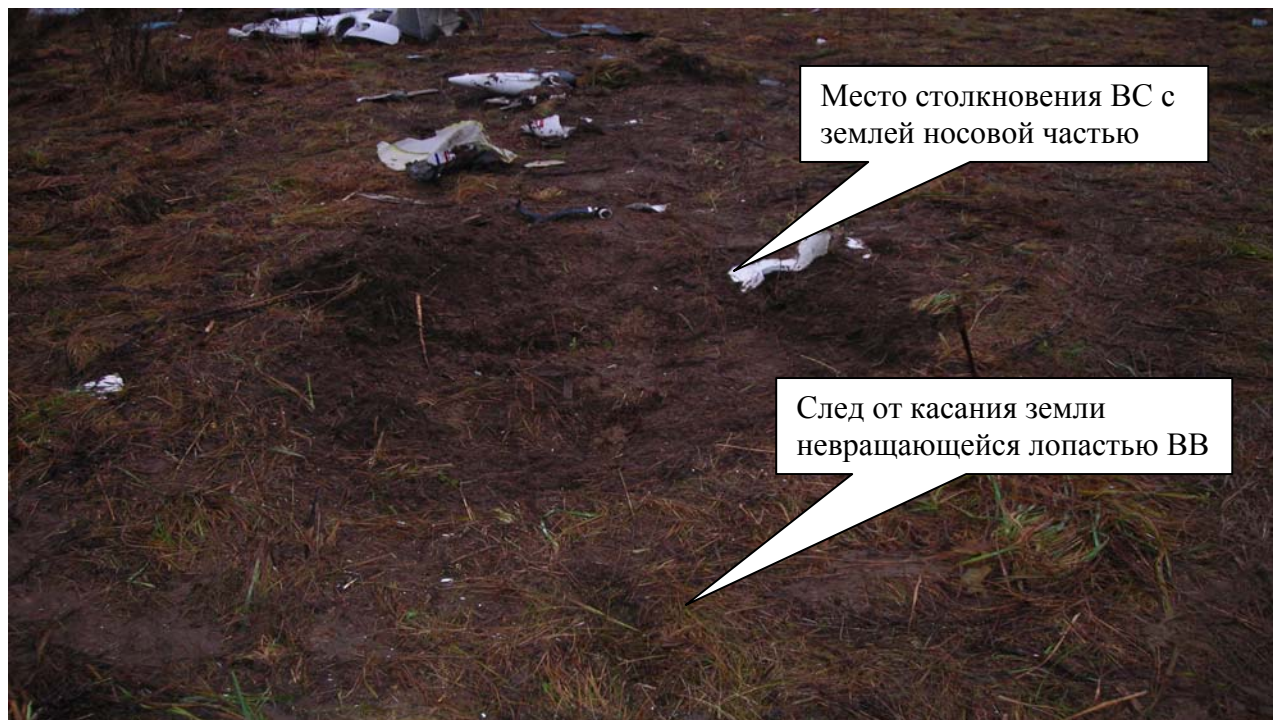
Рис. 2. Место столкновения носовой частью самолета с земной поверхностью.
