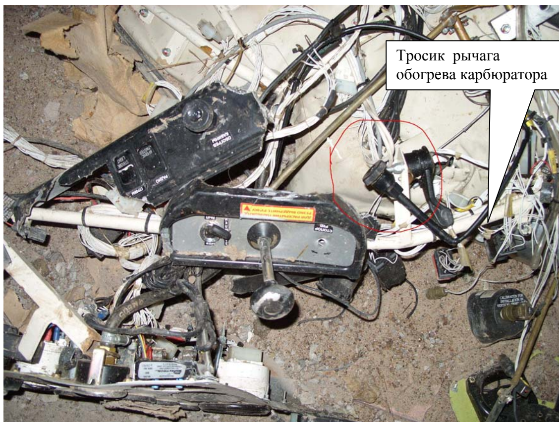
Рис. 3. Рычаг обогрева карбюратора
