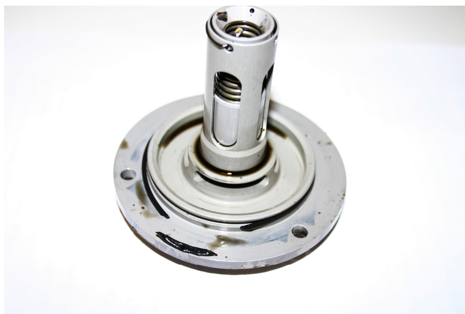
Рис. 7. Повреждения уплотнительного кольца крышки масляного фильтра после его разборки.
