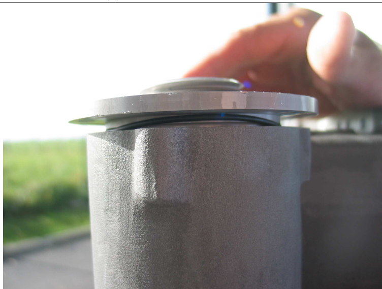
Рис. 11. Пример установки в картер двигателя крышки фильтра с неправильным положением уплотнительного кольца.
