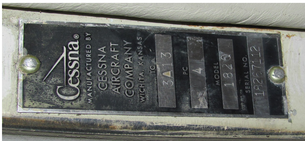
Рис. 12. Фото прикрепленного к стойке заводского шильдика
