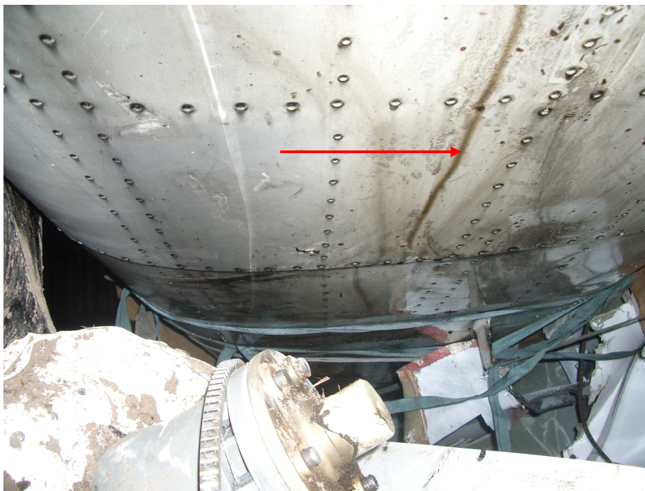
Рис. 4. Следы выброса масла на днище фюзеляжа.
