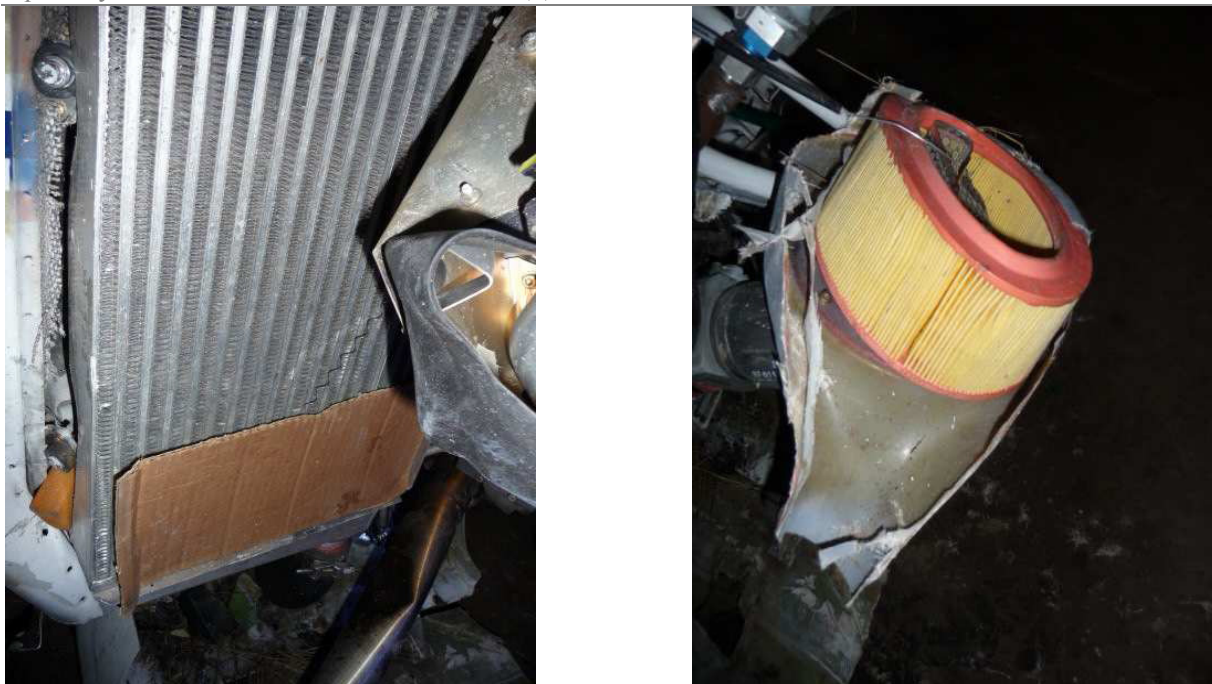
Рис. 1. Элементы нестандартного оборудования (затенение радиатора и воздушный фильтр)
