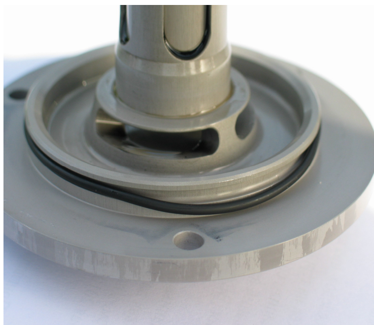
Рис. 8. Вид на крышку маслофильтра с неправильным положением уплотнительного кольца.
