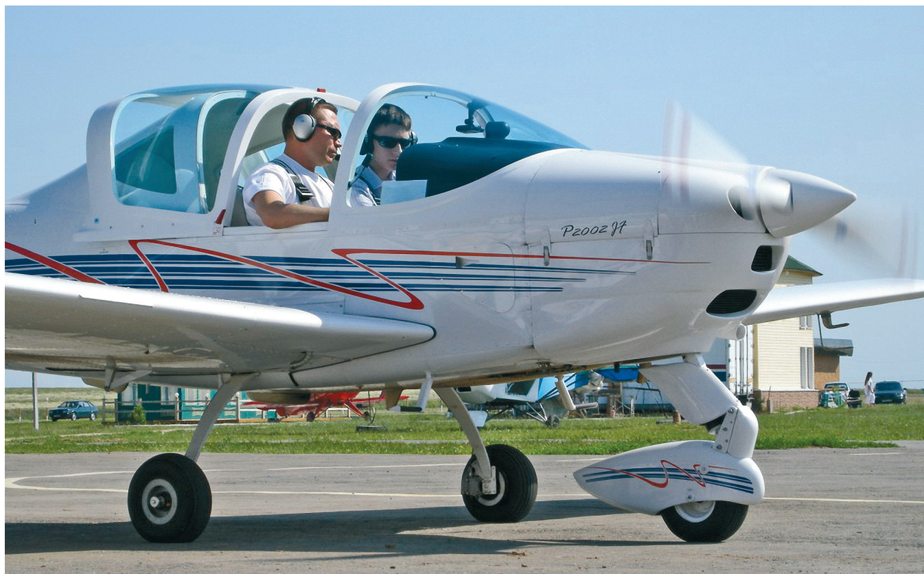
Благодаря рессорным основным стойкам шасси, P2002-JF может взлетать и садиться на неподготовленные полосы
