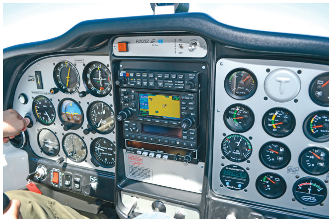
P2002-JF с аналоговым комплексом приборов
