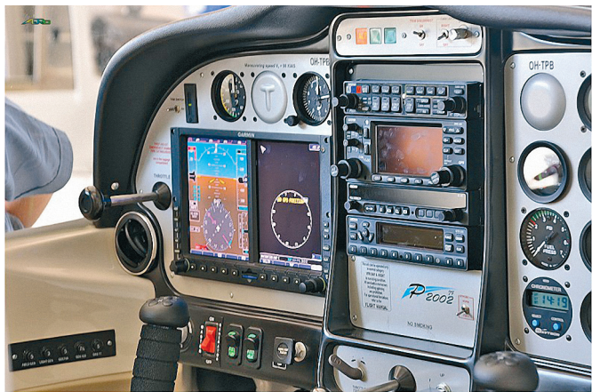
GARMIN GNS-430 – основа «стеклянной кабины» P2002-JF
