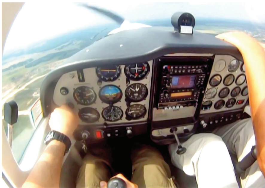
Сваливание во взлетной конфигурации (4500 об/мин, закрылки во взлетном положении - 15 )
