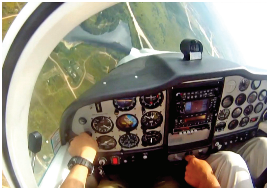
Сваливание с креном (малый газ, закрылки убраны)
