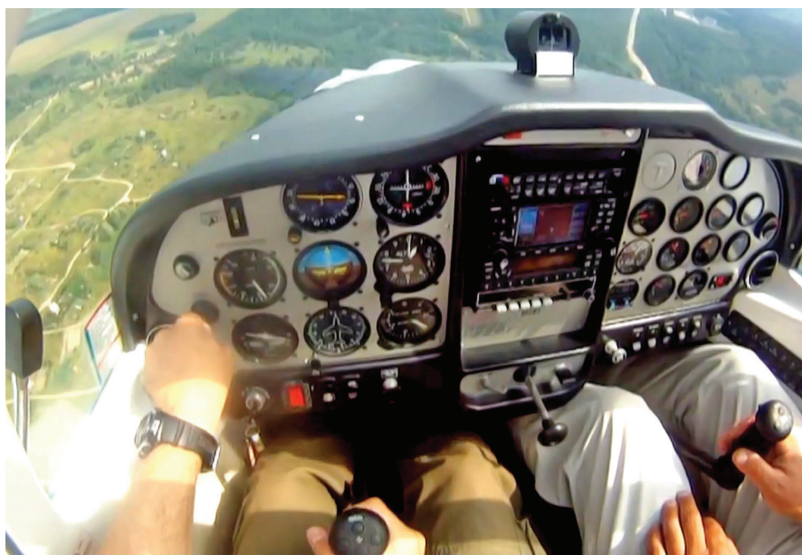
Опускание носа при сваливании (малый газ, закрылки убраны)
