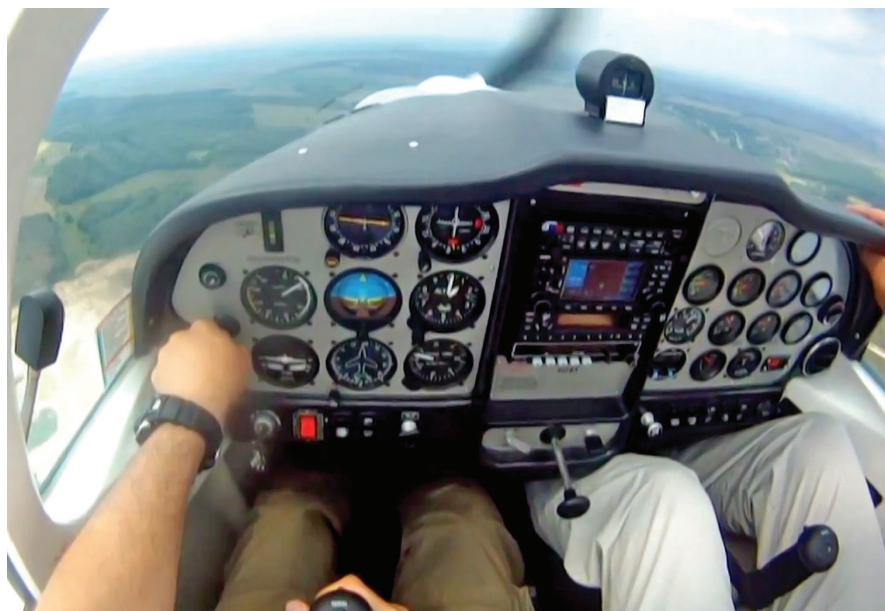
Перед началом сваливания (малый газ, закрылки полностью выпущены – 38°)
