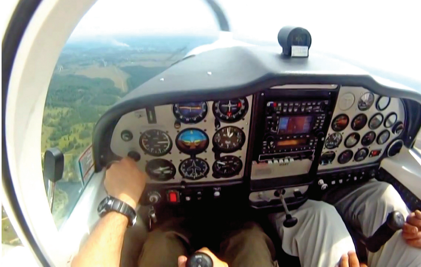
Перед началом сваливания (малый газ, закрылки убраны, горизонтальный полет)
