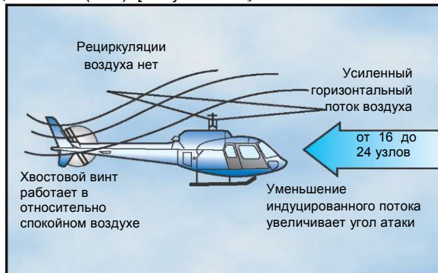
Рисунок 3-12. Эффективная подъемная сила от поступательного движения в полете легко определяется по кратковременной аэродинамической вибрации и увеличению мощности вертолета.
