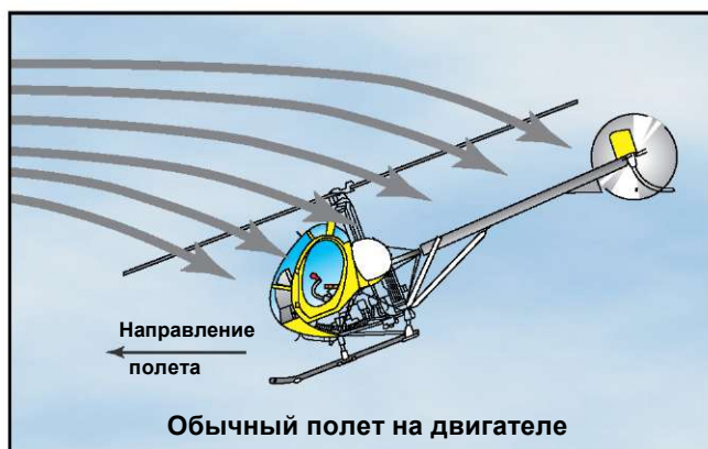
Рисунок 3-20. При авторотации поднимающийся воздушный поток (набегающий поток), позволяет лопастям несущего винта вращаться с обычной скоростью. Фактически лопасти "планируют" в плоскости вращения.
