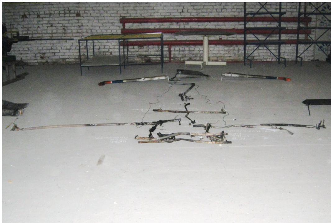
Рис. 12. Выкладка системы управления самолетом
