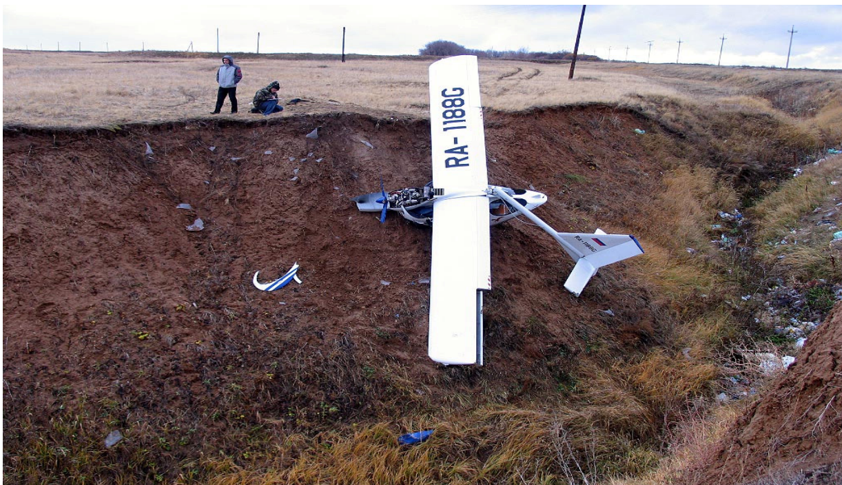
Рис. 4. Расположение обломков и фрагментов остекления кабины.
