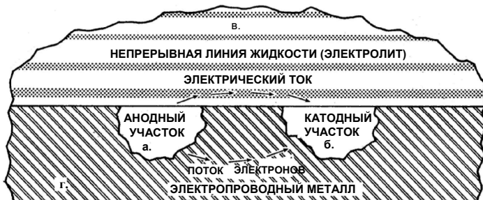
Рисунок 1. Идентификация коррозии
