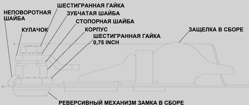
ВИД Б-Б ЗАМОК ПОКАЗАН В ЗАПЕРТОМ ПОЛОЖЕНИИ
